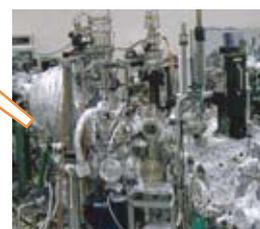
高分解能角度分解光電子分光装置
